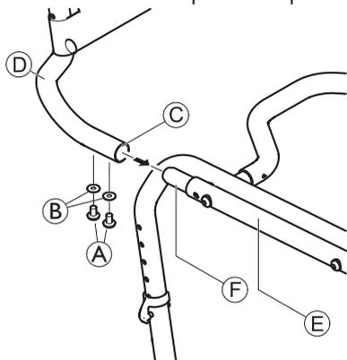
2. Inserire lo schienale ① dal retro del telaio della seduta ②, fino a che la fascetta ③ si attesta al tubo del telaio della seduta ④.
