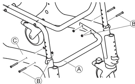
1. Posizionare il tubo di stabilizzazione di base (A) mediante le viti e i dadi (B) presenti tra le parti laterali (C).
