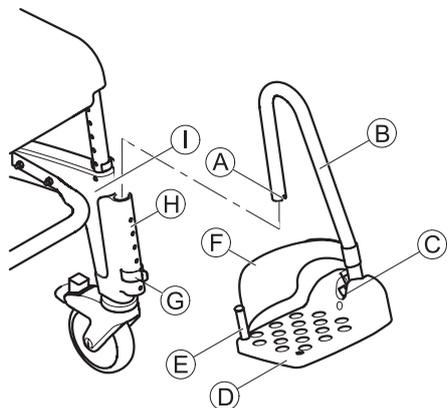
1. Introduzca empujando el reposapiés **B** con la paleta **D** en la guía **H** de la parte delantera de la pieza lateral **I** hasta que la ranura **A** encaje con el pasador del clip **G**. El reposapiés ya no podrá girarse hacia el lateral.
