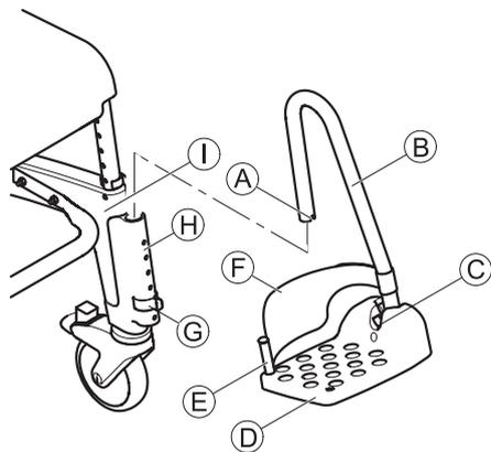
1. Poussez le repose-pied **B** avec la palette repose-pied **D** dans le guide **H** à l'avant de la pièce latérale **I** jusqu'à ce que la rainure **A** s'enclenche sur l'ergot du clip **G**. Le repose-pied ne peut plus être tourné sur le côté.
