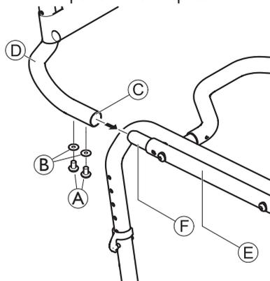
2. Insérez le dossier ④ par l'arrière dans le cadre du siège ⑤, jusqu'à ce que la bride ③ bute contre le tube du cadre du siège ⑥.
