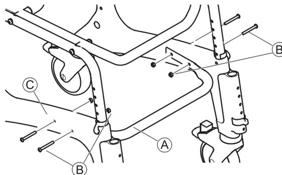
1. Instale o tubo de estabilização de base (A) utilizando os parafusos e as porcas facultadas (B) no meio das secções laterais (C).
