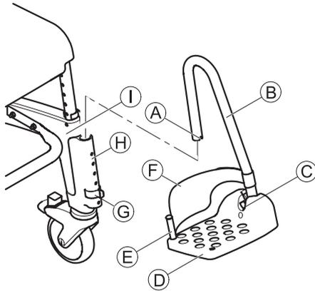
1. Druk de voetsteun **B** met de voetplaat **D** in de geleider **H** op de voorkant van het zijstuk **I**, tot de groef **A** in de pen van de klem valt **G**. De voetsteun kan niet meer opzij worden gedraaid.
