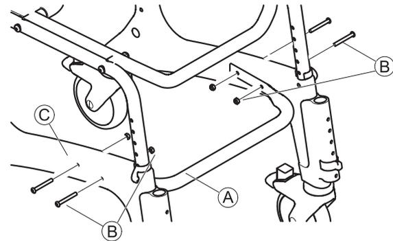
1. Basis-Stabilisierungsrohr (A) mit beigefügten Schrauben und Muttern (B) an das Sitzgestell (C) montieren.
