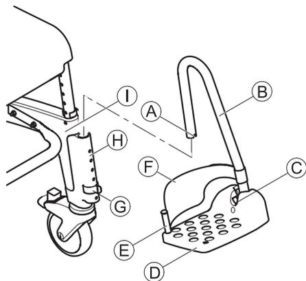
1. Empurre o apoio de pés **B** com a placa para os pés **D** para o interior da calha **H** na parte da frente da secção lateral **I** até que a rosca **A** engate no pino do grampo **G**. O apoio de pés deixa de poder ser virado de lado.
