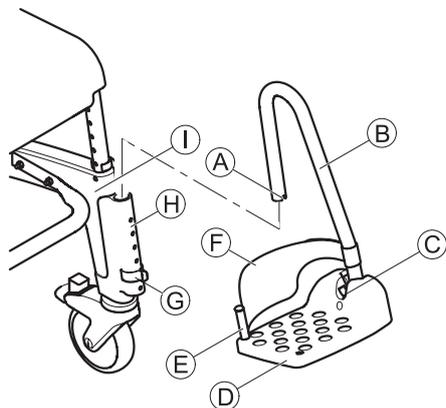
1. Die Fußstütze **B** mit der Fußplatte **D** nach innen in die Führung **H** vorne am Seitenteil **I** einschieben, bis die Nut **A** in den Stift des Klipps **C** eingreift. Die Fußstütze lässt sich seitlich nicht mehr drehen.
