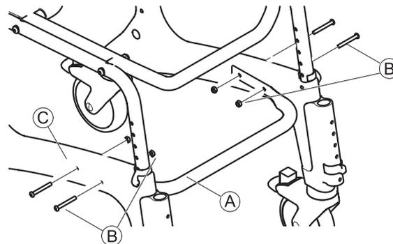
1. Ajuste el tubo de estabilización de la base (A) utilizando los tornillos y las tuercas facilitados (B) entre las piezas laterales (C).
